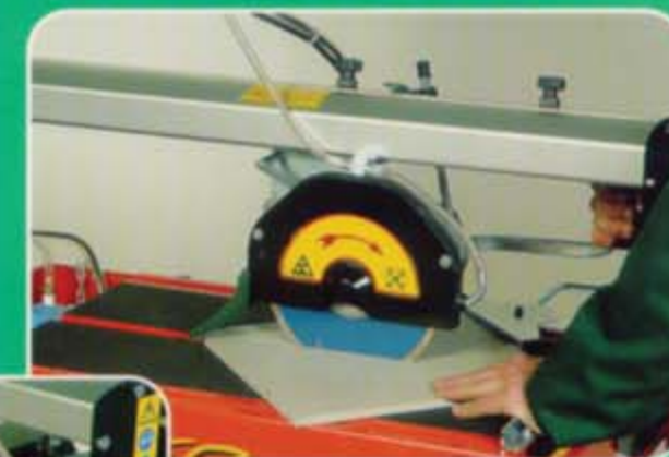
Regolazione progressiva dell'altezza di taglio
